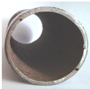
Рисунок 1 Отрезок стальной трубы с отражателями «цилиндрическое отверстие»
